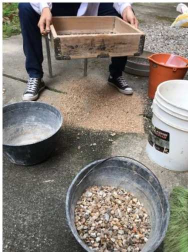
Figura 1C. Proceso tamizado grava gruesa
