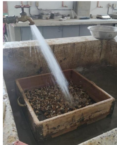
Figura 2C. Proceso de lavado de la grava
