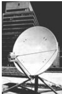
Figura 138. Unidad Exterior de una estación VSAT.
