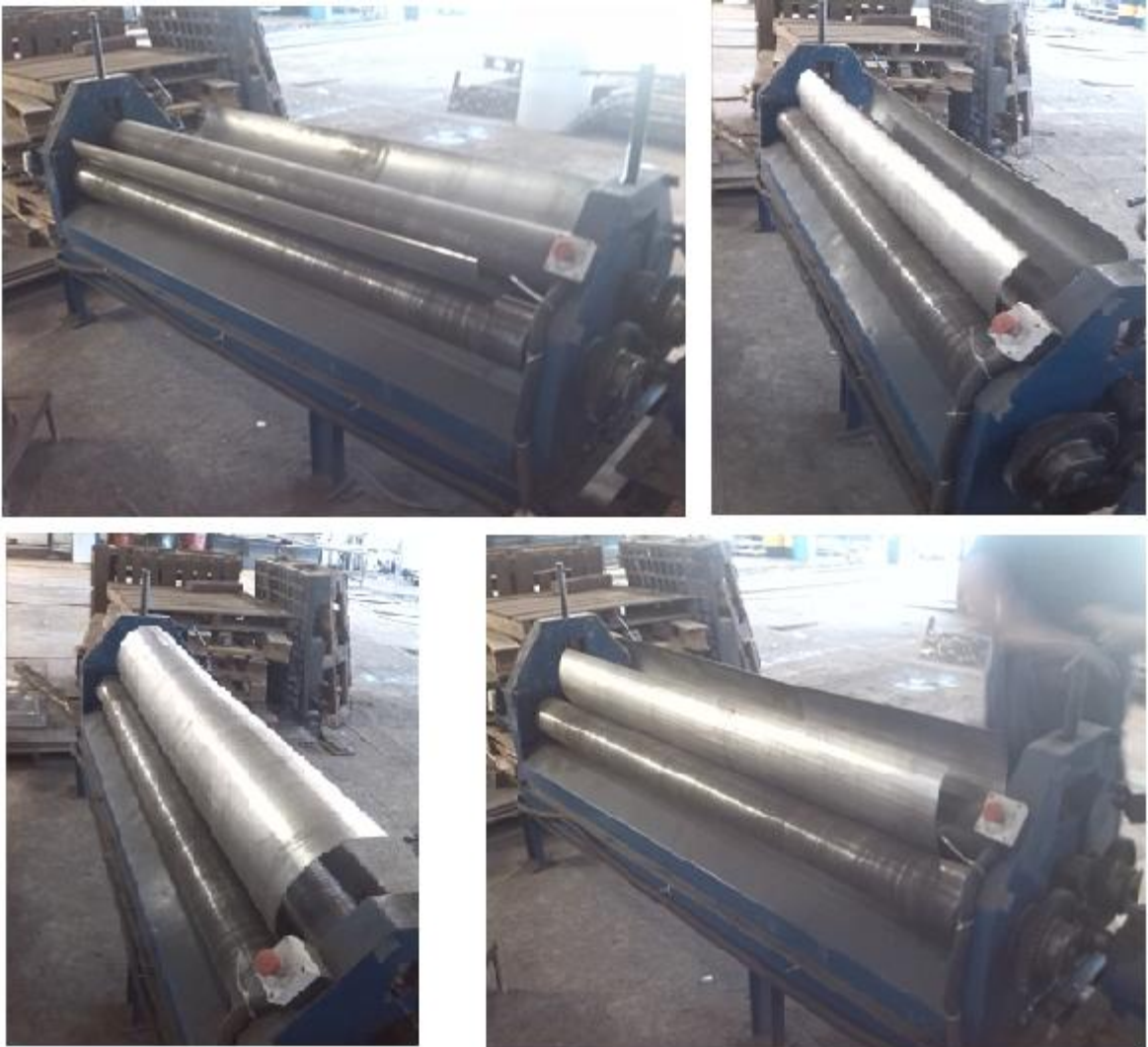
Figura 60. Proceso de cilindrado de lámina de acero
