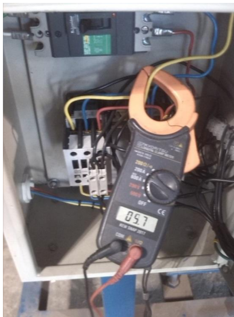
Figura 62. Consumo de corriente durante el trabajo de la máquina - prueba 1
