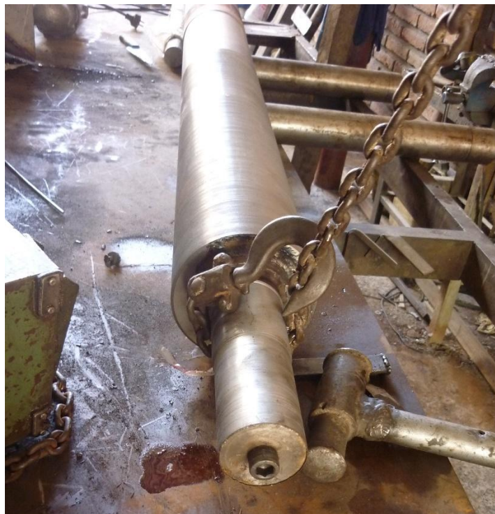
Figura 46. Maquinado de las puntas - ejes de los rodillos.
