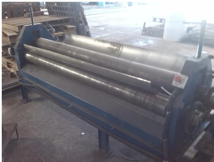
Figura 59. Montaje de lámina de acero en la cilindadora.
