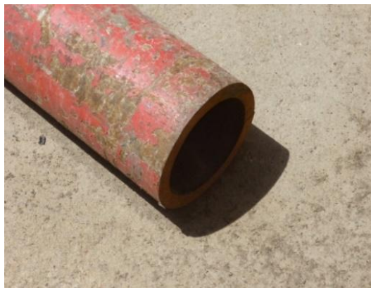
Figura 44. Material para la fabricación de los cilindros, Acero ASTM A53 grado A.
