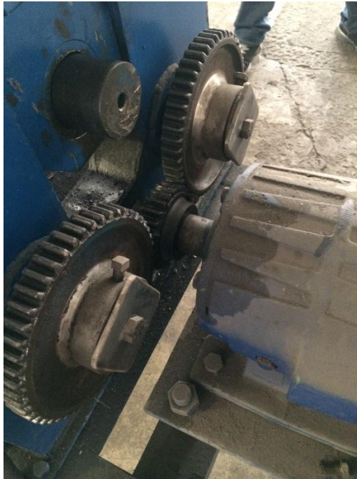
Figura 52. Montaje de rodillo movil y sistema de transmision de potencia.
