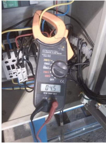
Figura 57. Registro del consumo de corriente con la máquina en vacío.
