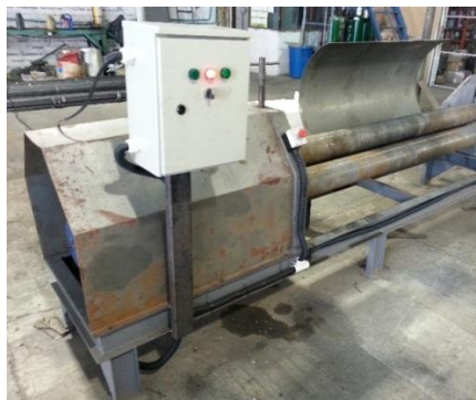
Figura 53. Instalación sistema eléctrico y guarda del motoreductor.
