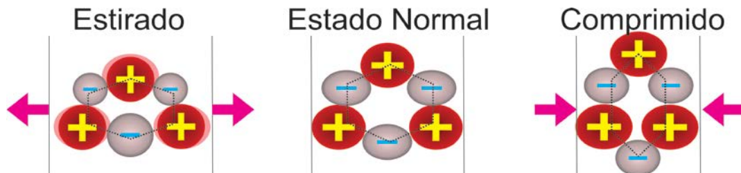
Figura 3. Átomos de silicio con carga positiva y oxígeno con carga negativa en un cristal de cuarzo. 12
