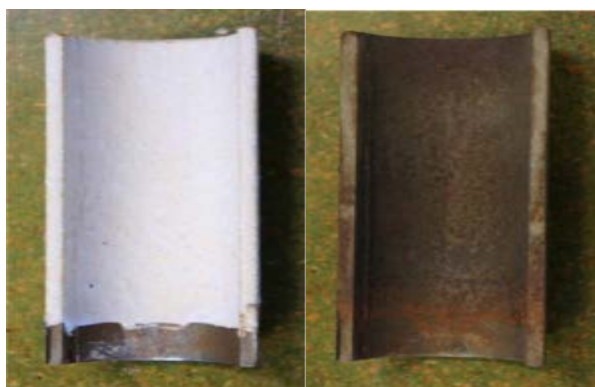
Figura 13. Muestra V57 antes y después del tratamiento con ultrasonido. 45
