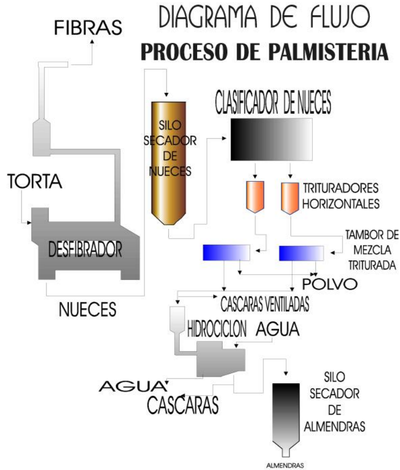
Figura 21. Diagrama de flujo para el proceso de Palmistería
