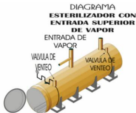
Figura 14. Diagrama de esterilizador horizontal (diseño de mayor uso en las plantas de beneficio en Colombia).
