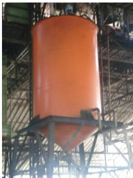
Figura 18. Clarificador continuo de aceite rojo de palma
