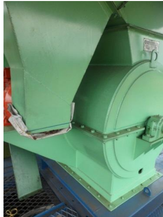
Figura 24. Prensa de Almendra (nombre comercial Expeller)
