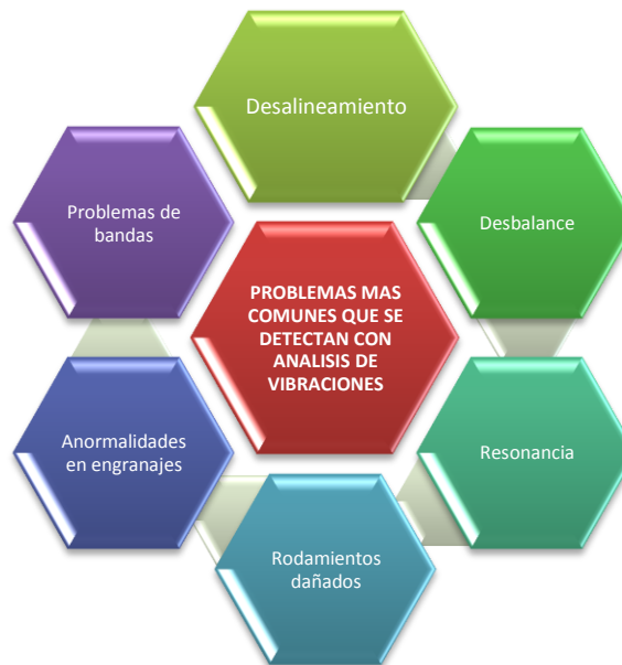
Figura 42. Problemas detectados con análisis de vibraciones.
