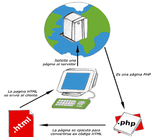
Figura 2. Funcionamiento de las páginas PHP.
