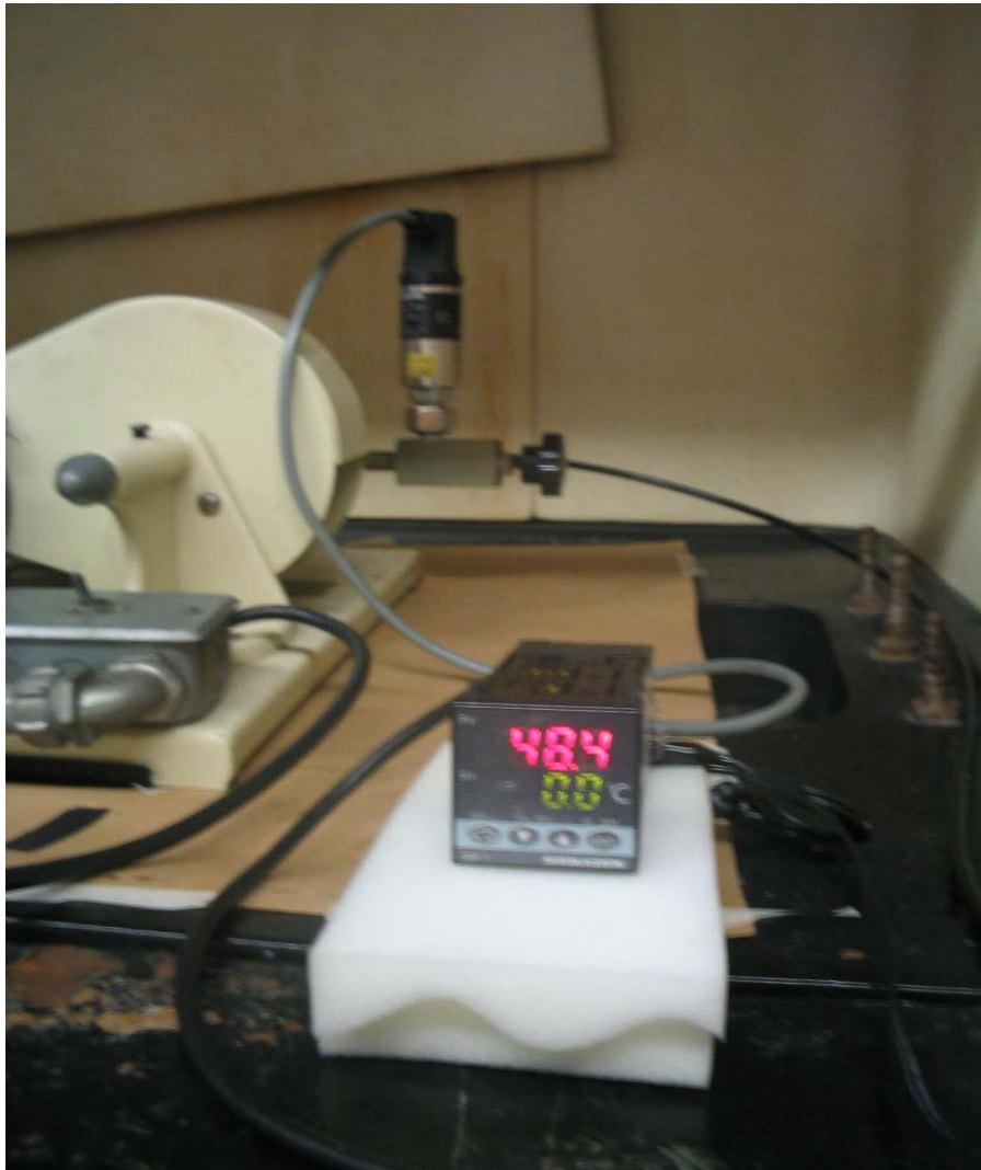
Trasductor y registrador de señal.
