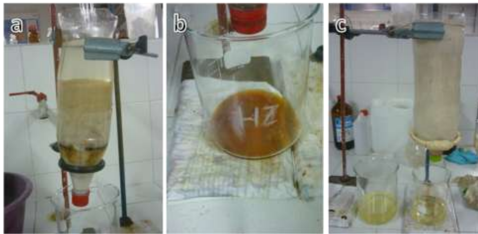
Figura 8. Proceso de purificación de la sílice post-consumo. a) Lavado con etanol en columna, b) líquido eluyente inicial y c) final de lavado con etanol.
