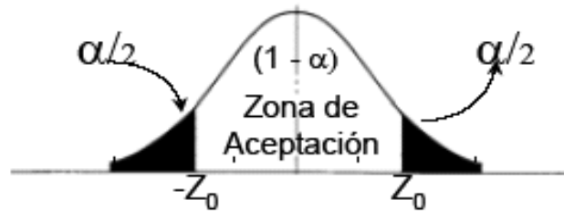
Figura D1. Esquema de la zona de aceptación para el caso de comparaciones entre yacimientos similares.
