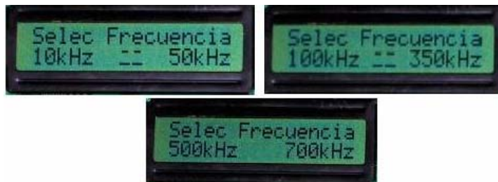
Figura 45 Valores de Frecuencia para la Señal Senoidal
