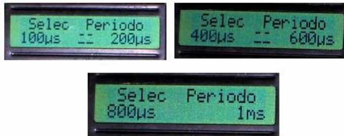
Figura 47 Valores de Periodo para Señal de Pulsos Bifásicos
