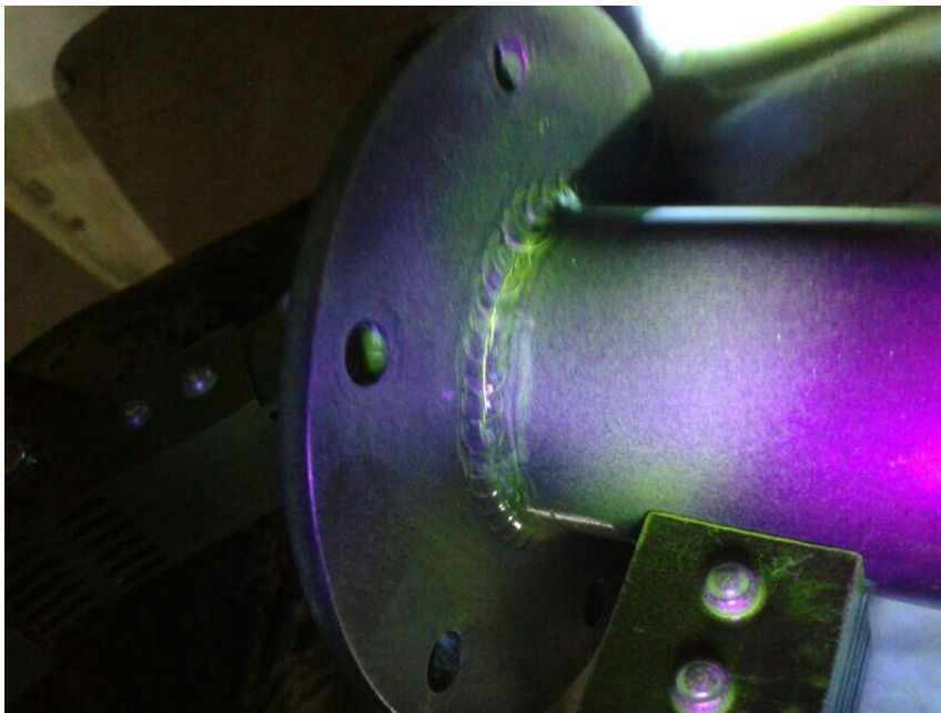
FIGURA 8. INDICACION DE FALLA MEDIANTE NDT.
