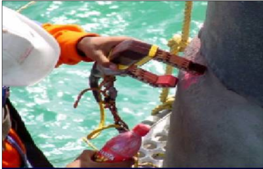
Figura 7. Inspección de un Oleoducto con Partículas Magnéticas.
