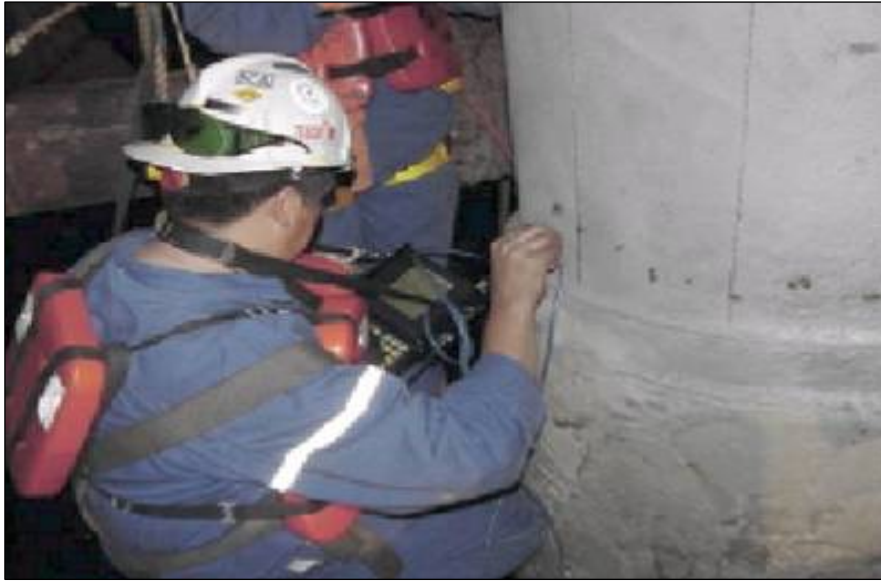
Figura 8. Inspección Ultrasónica de un Oleoducto.
