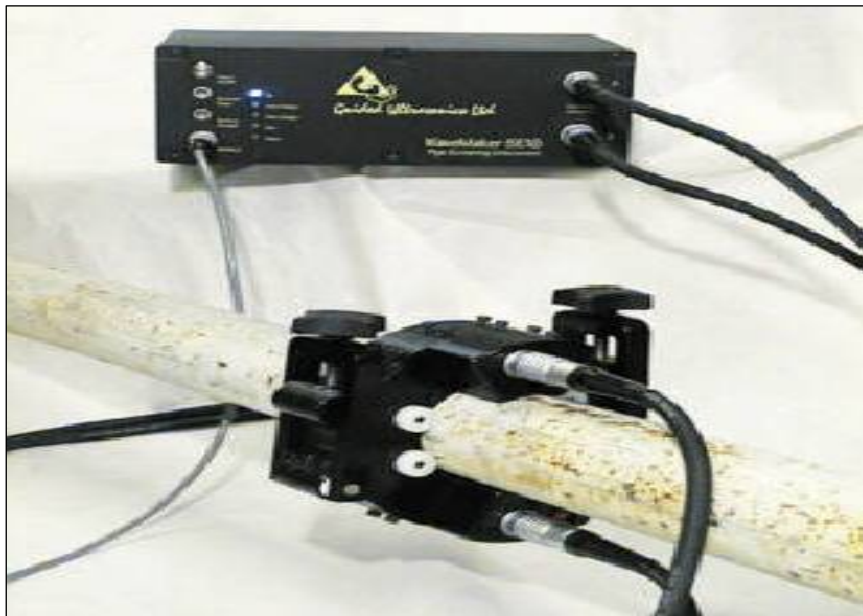
Figura 5. Inspección con SCAN en tubería de 2" de diámetro.
