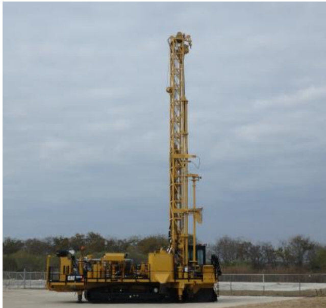
Ilustración 1. Taladro Caterpillar MD 6250. (Caterpillar Inc., 2018)
