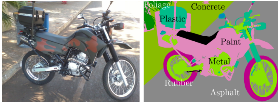
Figura 2. Ejemplo de segmentación de materiales aplicada a una imagen RGB, ilustrando la identificación y clasificación de diferentes materiales como metal, plástico, concreto y caucho. Tomado de. 31
