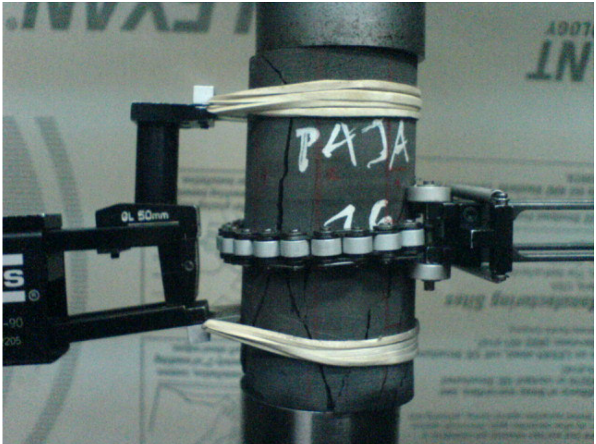
Figura 60. Fractura generada como resultado de la prueba de Compresión Uniáxial sobre un plug de la formación Paja. Fuente: El Autor del Proyecto.
