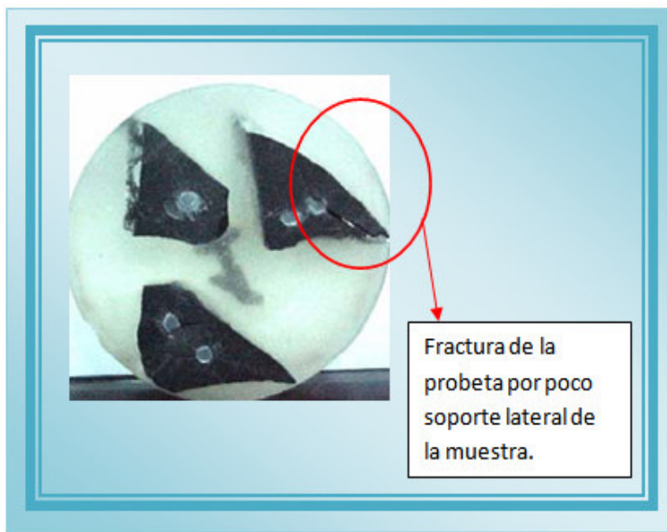
Figura 30. Probetas utilizadas en trabajos anteriores de tamaño muy pequeño, ocasionando fracturas de las probetas. Fuente: M.T Jefferson 2005.
