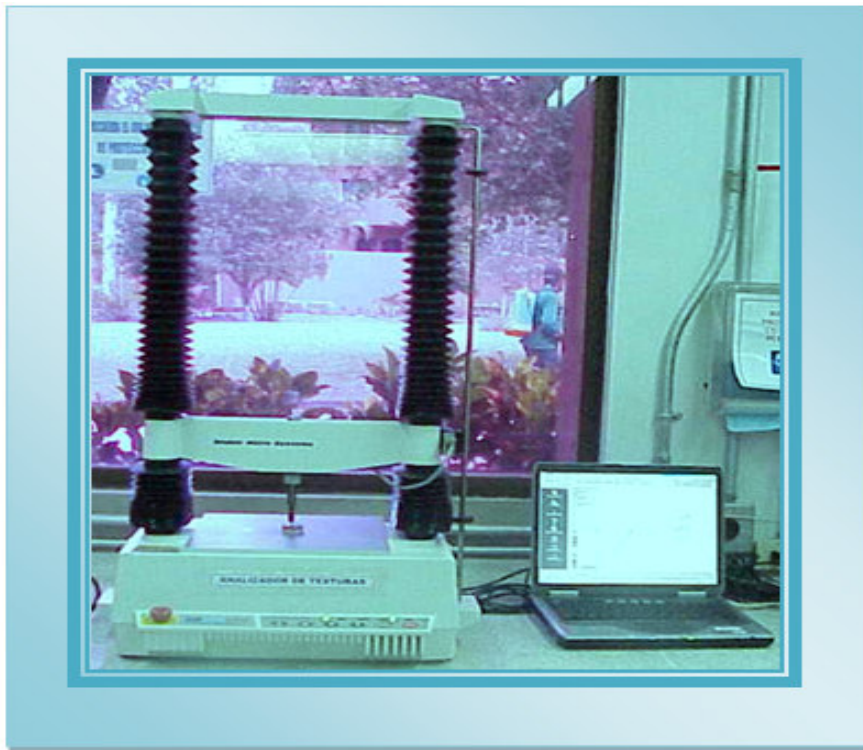
Figura 33. Equipo utilizado para realizar todas las pruebas de Indentación del proyecto. Fuente: El Autor del Proyecto.
