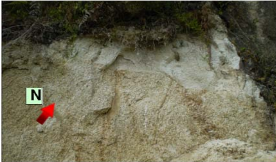
Figura18: Afloramiento Cuarzomonzonita de la corcova con alto grado de meteorización química por disolución parte central de la cuenca, cercanía al río Lato.
