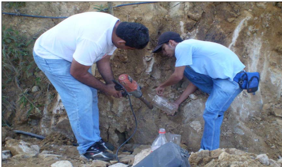
Figura 6. Extracción del núcleo adicionando agua contacto taladro-roca.
