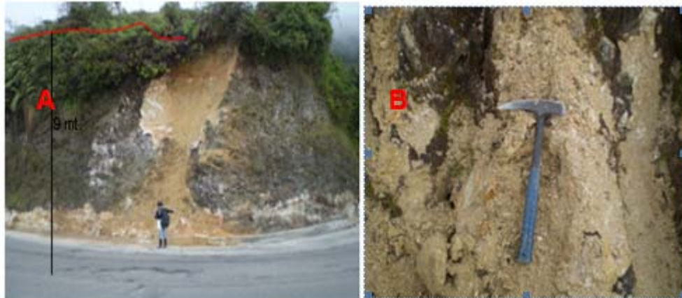
Figura32 A: Afloramiento Gneis con alta grado de meteorización, se muestra un perfil de meteorización de 9m. de espesor y sobre el tope una capa de materia orgánica. B: Gneis detalle del afloramiento.
