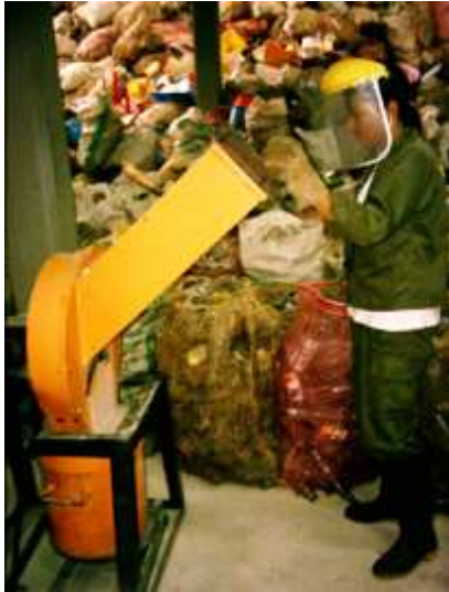
Foto 8. Proceso de molienda de casco de vidrio
