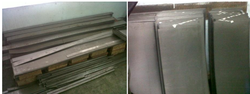
Figura 41. Láminas y tiras de acero cold rolled sin identificación
