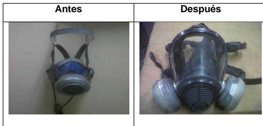
Cuadro 16. Máscaras para el proceso de pintura
