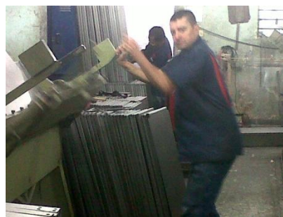
Figura 22. Operario doblando sin elementos de protección.
