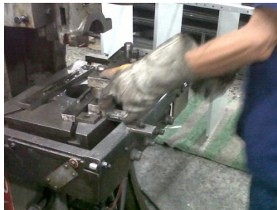
Figura 15. Desmontaje de troquel
