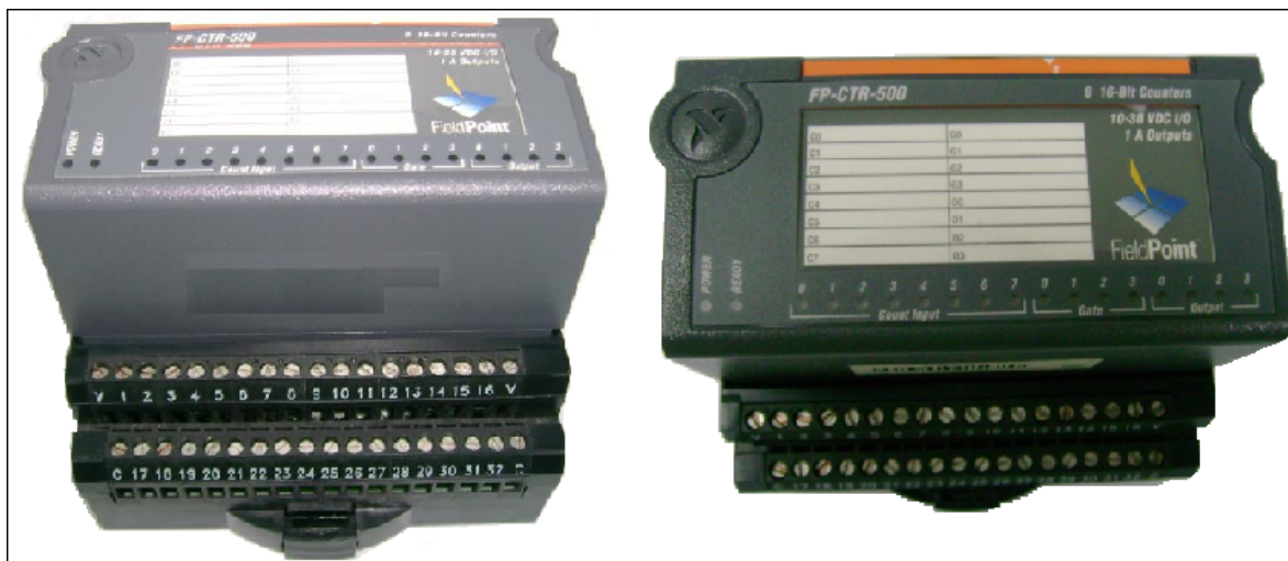
Figura 29. Modulo Contador FP-CTR 500
