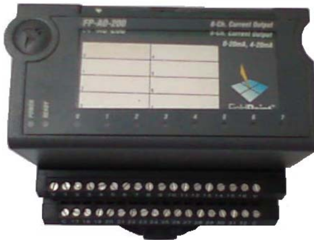
Figura 26. Modulo de salidas analógicas FP-AO-200.
