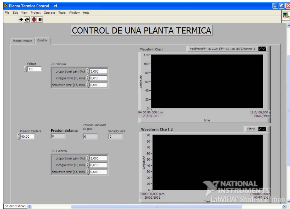
Figura 72. Panel Frontal Planta Térmica (Control)
