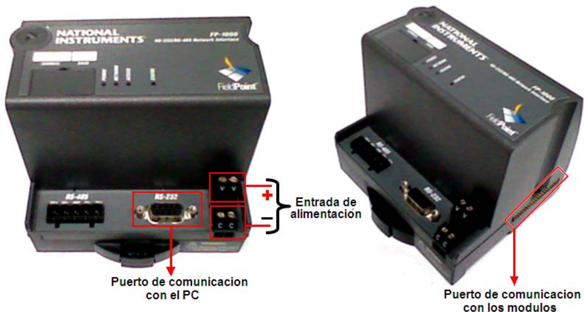
Figura 23 Modulo de comunicación FP – 1000.
