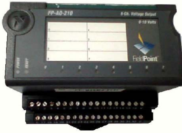
Figura 25. Modulo de Salidas Analógicas FP-AO-210.
