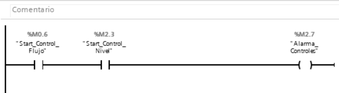
Figura 49. Lógica para selección exclusiva de controlador
