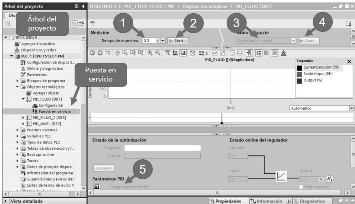
Figura 36. Ventana para sintonización automática de bloque PID
