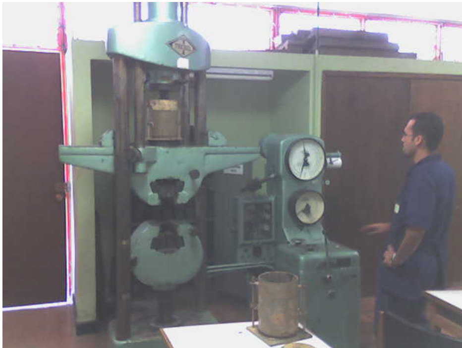
Figura 8. Aplicación de carga a muestra compactada por medio de la máquina Universal
