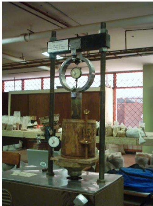
Figura 5. Ensayo de CBR de laboratorio
