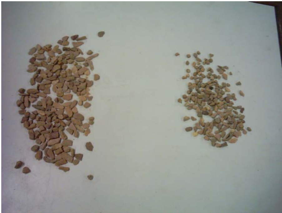
Figura 7. Muestra de Río de Oro para la medición de índices de alargamiento y aplanamiento
