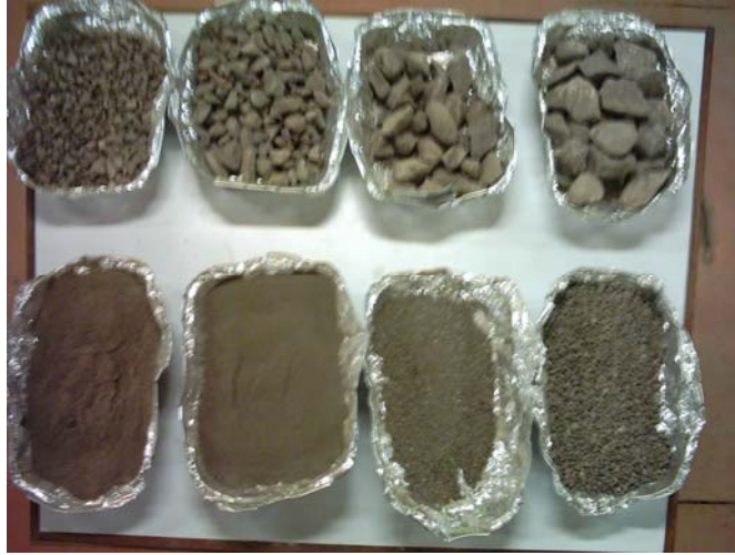
Figura 2. Muestra preparada por tamaños para su ajuste a BG-1
