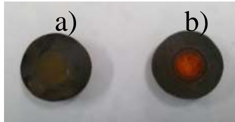
Figura 9. Imágenes de las muestras con productos de corrosión luego de exposición a 672 h de solución de 3,5% en peso de NaCl. (a) Muestra O1, (b) Muestra N1.
