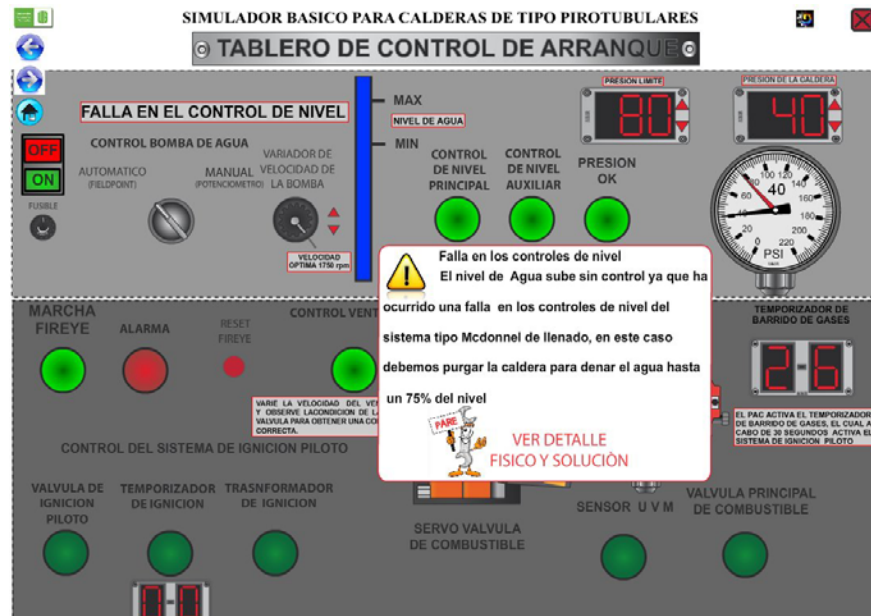
Figura 74. Falla en el control de nivel de la caldera
