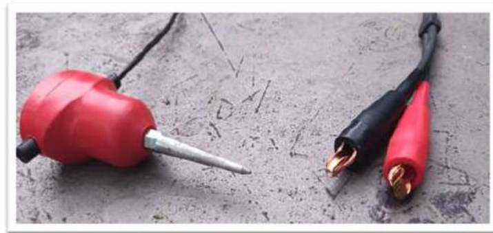
Figura 2. Geófonos de 4.5 Hz de frecuencia natural
