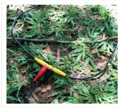
Figura 13. Conexión cable principal geófonos
