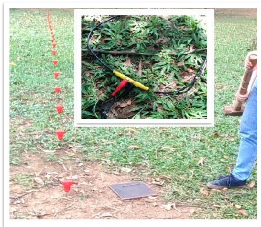
Figura 4. Conexión geófonos al cable principal
