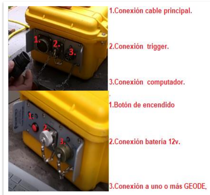
Figura 5. GEODE múltiples conexiones.
