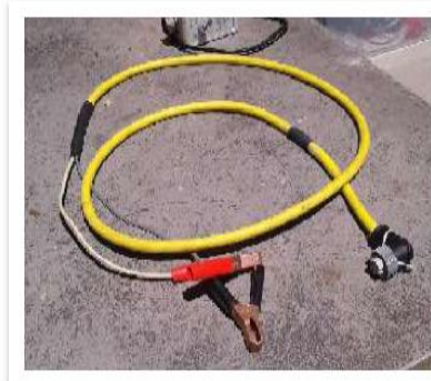
Figura 6. Cable de batería -Geode
