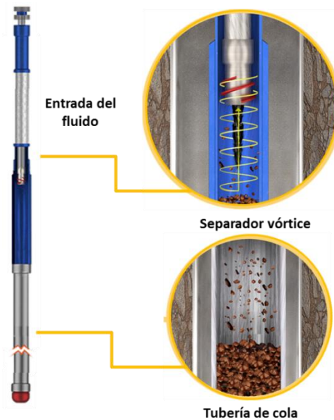
Figura 22. Separador Vortex. Adaptado de Odessa Separator. (2018). Recuperado de https://www.odessaseparator.com/vortex-sand-shield
