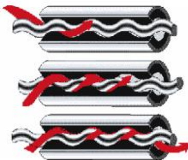
Figura 15. Funcionamiento de una PCP. Tomado de Hirschfeldt, M. (2008). Manual de Bombeo de Cavidades Progresivas. PCPump-Handbook Versión 2008V1. Recuperado de http://www.oilproduction.net/files/PCPump-Handbook-2008V1.pdf
