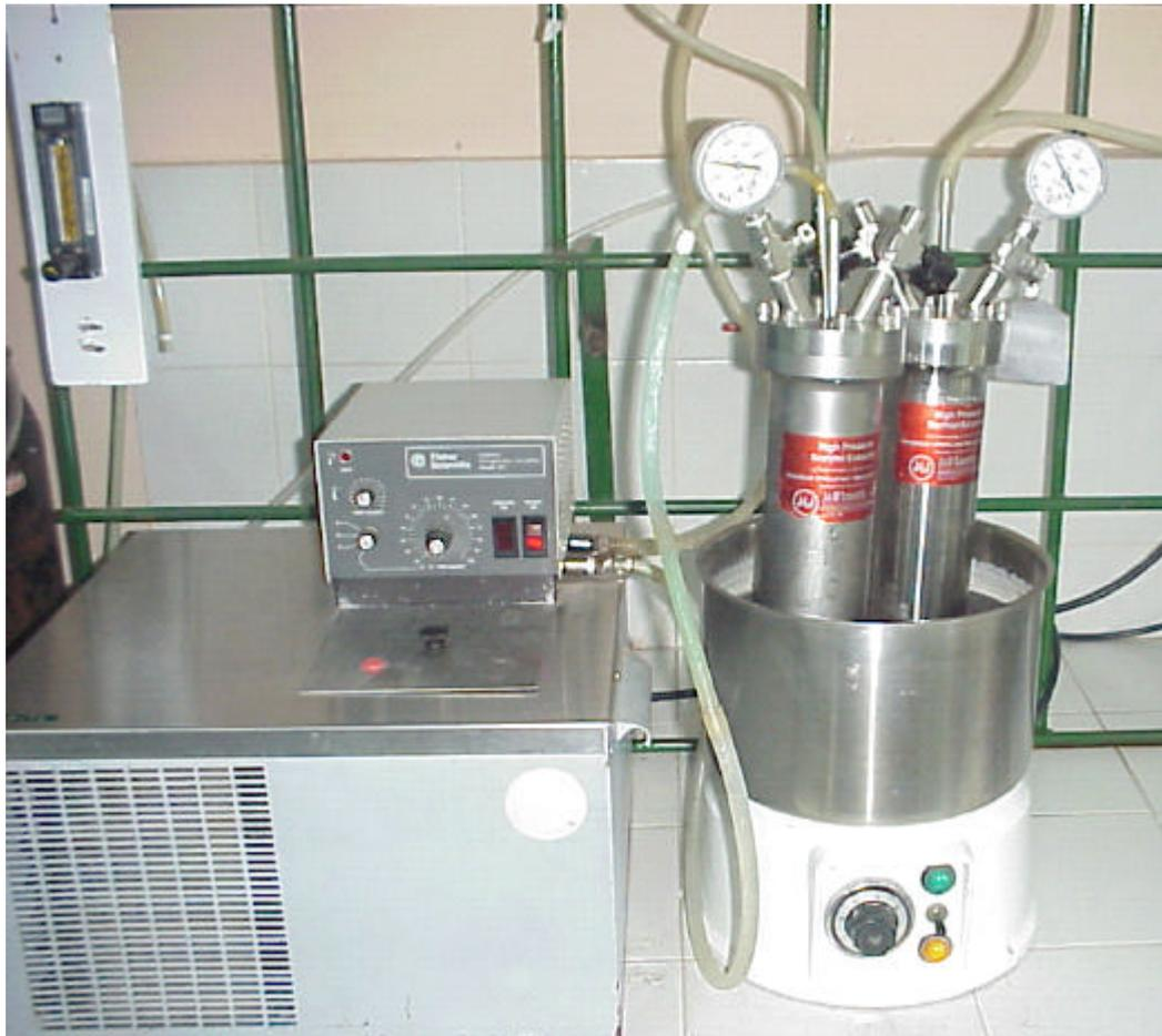
**Figura 5.** Equipo de extracción *headspace* dinámico (purga de espacio de cabeza con  $N_2$  y trampa en solvente simultánea, P & T).
