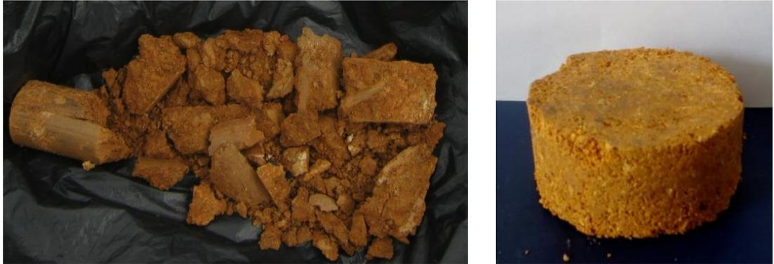
Se reconstituyeron 36 muestras, utilizando el material recuperado de los ensayos de exploración, dichas muestras se reconstituyeron, bajo condiciones controladas para obtener pesos unitarios específicos. En la Tabla 8 se detallan los resultados.
