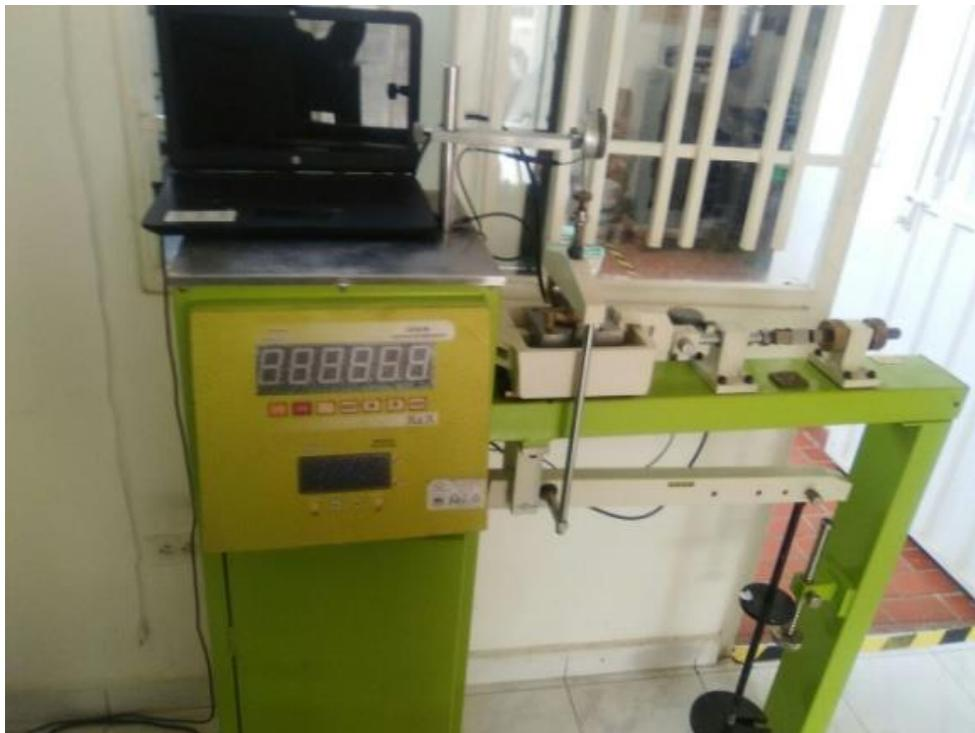
**5.1.1 Cortes directos sobre muestras inalteradas.** Los ensayos de corte directo se realizamos de muestras recuperadas, con tubo Shelby, de bancos o cubos de suelo moldeados y extraídos del apique ver Fotografía 5, al igual de muestras en la que se hincó directamente grupos de 3 moldes sobre una superficie perfilada y plana ver Fotografía 6.
