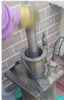
Figura 6. Fabricación de probetas Marshall.
