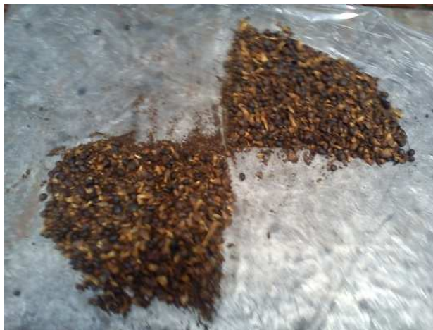
Figura 171. Mezcla triturada con dos cuartos removidos
