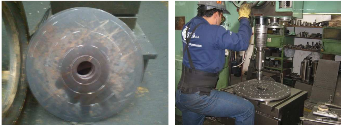
Figura 148. Materia prima y mecanizados placa móvil
