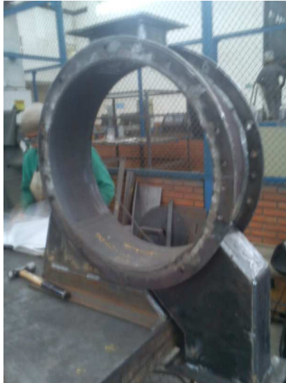
Figura 155. Fabricación cuerpo soldado carcasa
