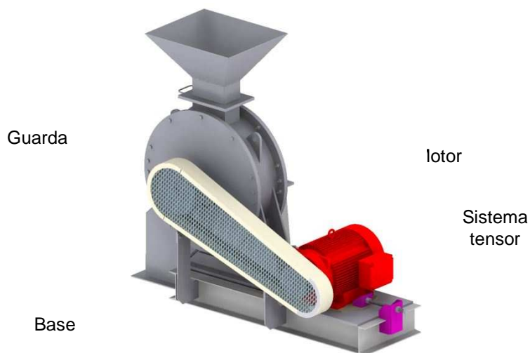
Figura 19. Vista general del rompedor
