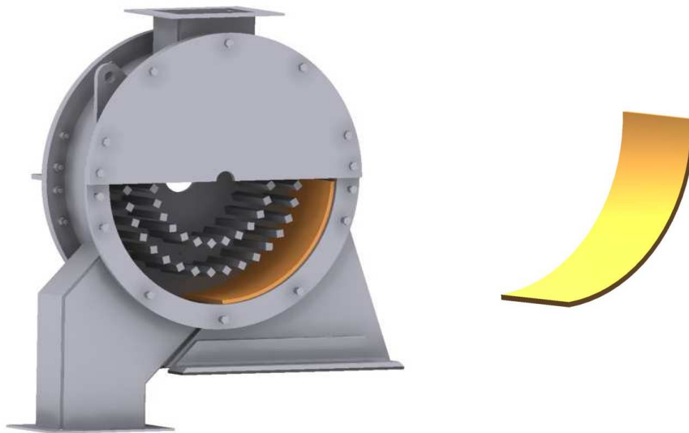
Figura 31. Ubicación e isométrico placa rompedora
