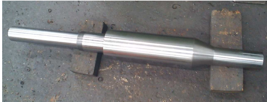
Figura 153. Eje rotor mecanizado
