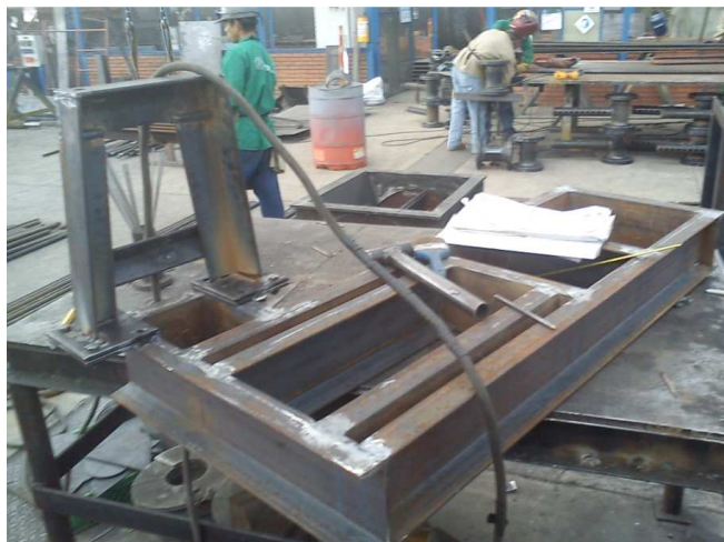
Figura 156. Fabricación base y soporte posterior
