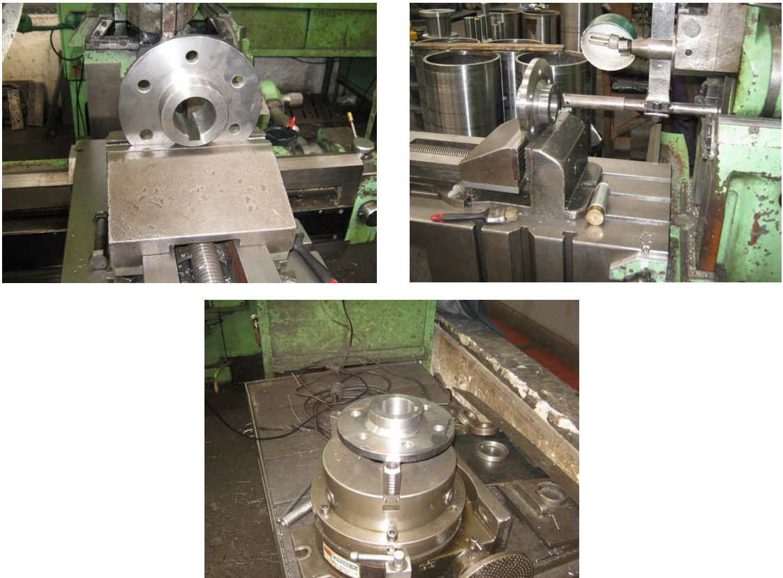
Figura 152. Mecanizado manzana lateral
