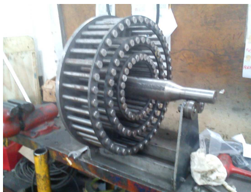
Figura 159. Rotor sobre dispositivo de balanceo
