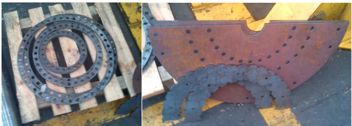
Figura 149. Materia prima aros protectores placa posterior y aseguradores
