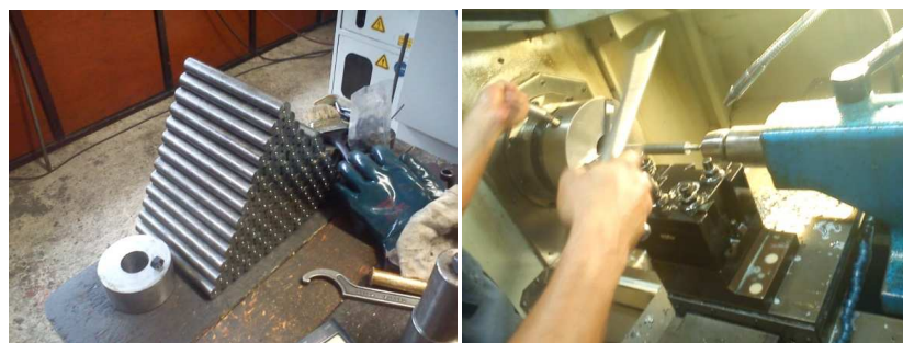
Figura 145. Materia prima y mecanizado de las barras móviles
