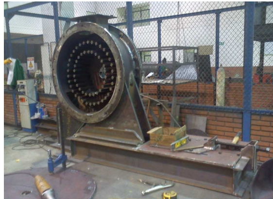
Figura 162. Ensamble tapa posterior y barras fijas sobre ensamble soldado carcasa
