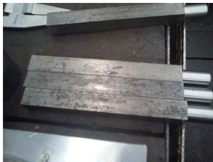
Figura 154. Barras fijas mecanizadas
