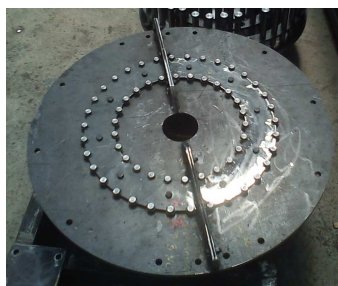
Figura 161. Ensamble tapa posterior aseguradores y barras fijas
