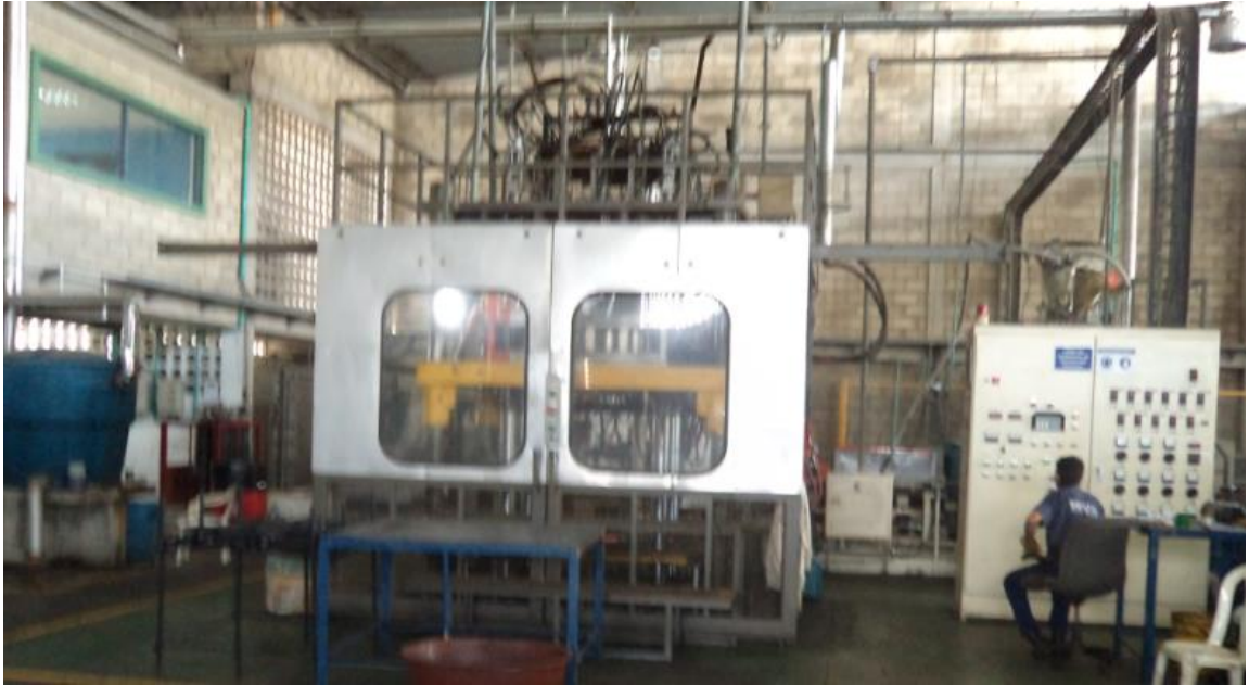
Figura 29. Máquina de espumado estructural de 300 Ton de cierre
