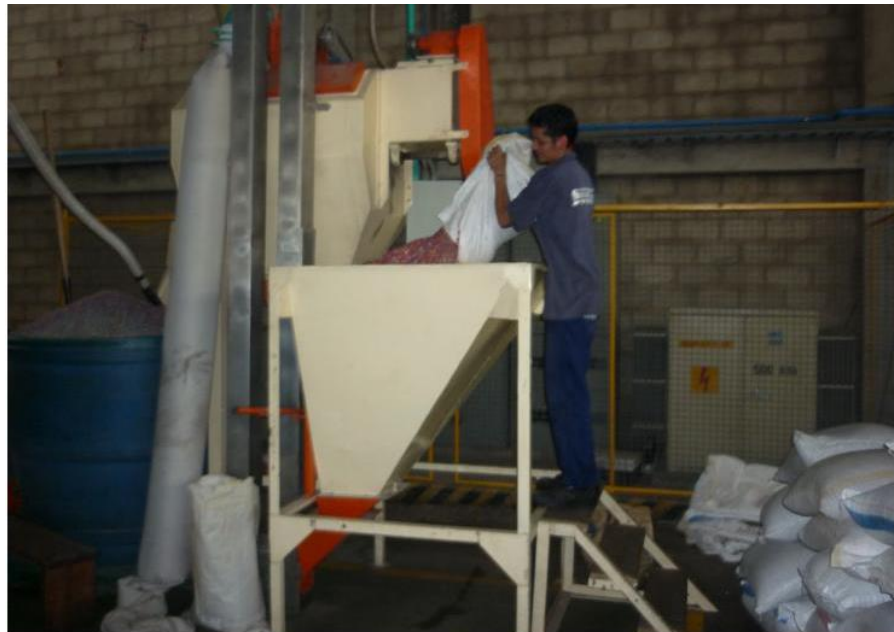
Figura 34. Vertimiento de la materia prima reciclada
