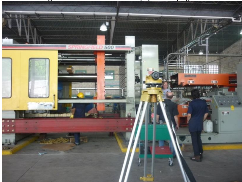
Figura 79. Nivelación con equipo de topografía
