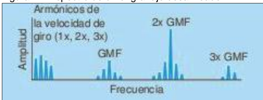
Figura 21. Espectro de un engranaje desalineado.
