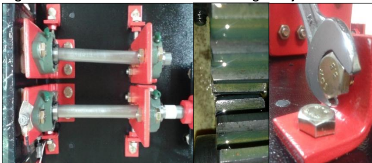
Figura 114. Desalineamiento De Engranajes.
