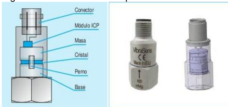
Figura 3. Partes transductor piezoeléctrico
