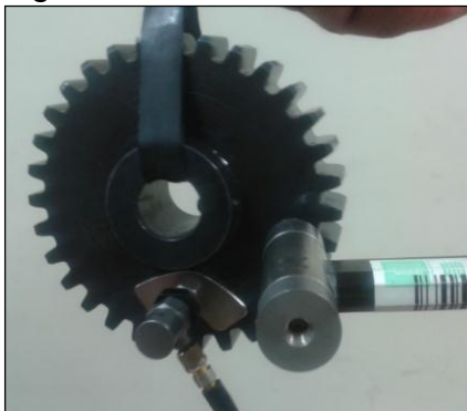
Figura 72. Prueba de frecuencia natural Engranaje
