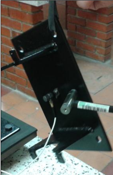
Figura 68. Prueba de frecuencia natural de la base del motor
