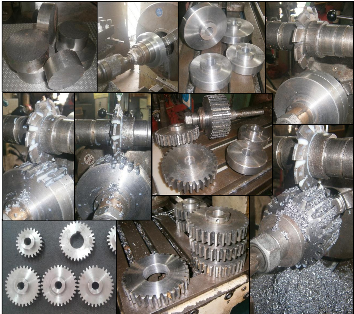
Figura 99. Proceso de manufactura de los engranajes
