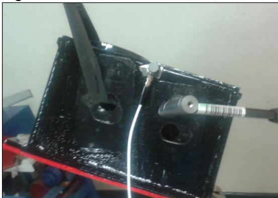
Figura 70. Prueba de frecuencia natural Caja de Engranajes
