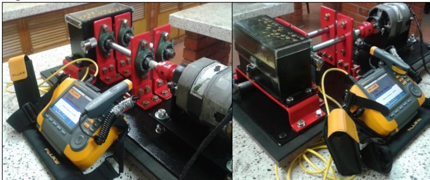
Figura 117. Medición con analizador de vibraciones Fluke 810.
