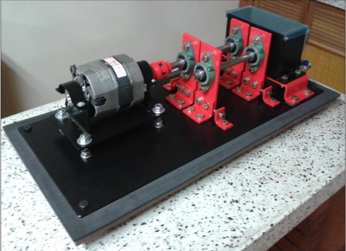
Figura 103. Ensamble banco de pruebas de fallas en engranajes rectos
