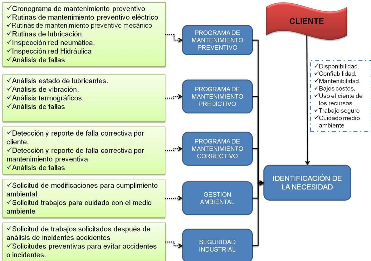
Figura 24. Identificación de la necesidad de mantenimiento.
