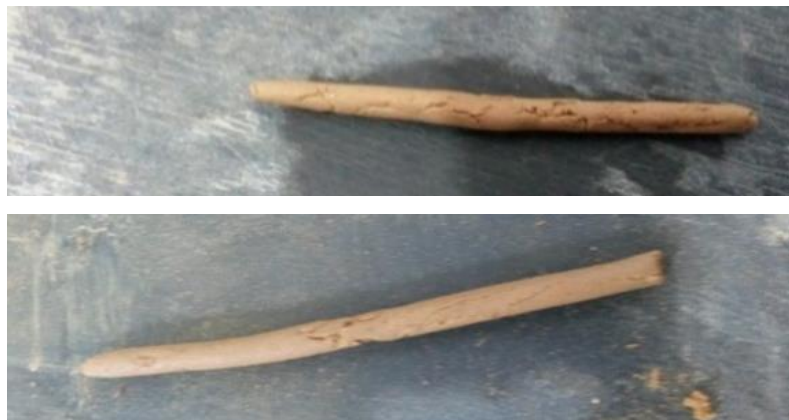
Figura 5. Presencia de grietas en rollos (ensayo límite plástico)
