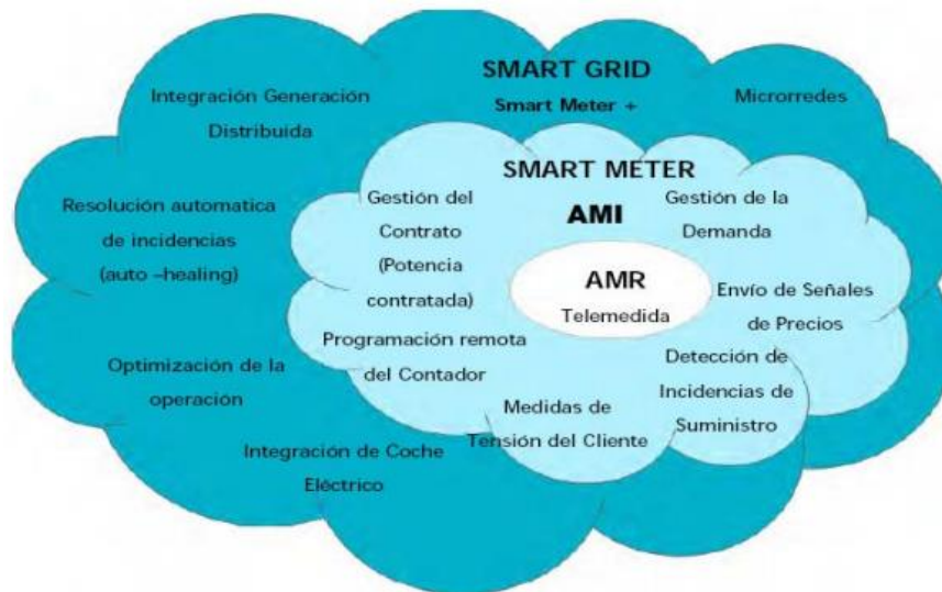
Figura 3. El primer paso para los Sistemas de Tele-gestión AMI. Adaptado de: INDRA. (2010). Las redes eléctricas inteligentes: El aporte de las TIC. Recuperado de: https://www.etsisi.upm.es/sites/default/files/estudios/smart%20grids.pdf
