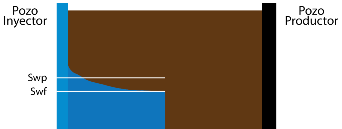
Figura 7. Representación del yacimiento antes de ruptura según Buckley -Leverett
