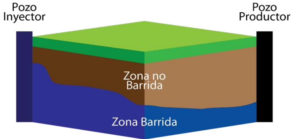
Figura 3. Esquema ilustrativo de la eficiencia de barrido volumétrica
