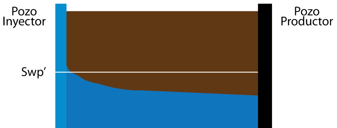
Figura 8. Representación del yacimiento después de ruptura según Buckley-Leverett.
