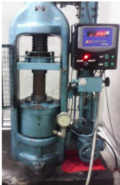
Figura 1. Montaje ensayo a compresión
