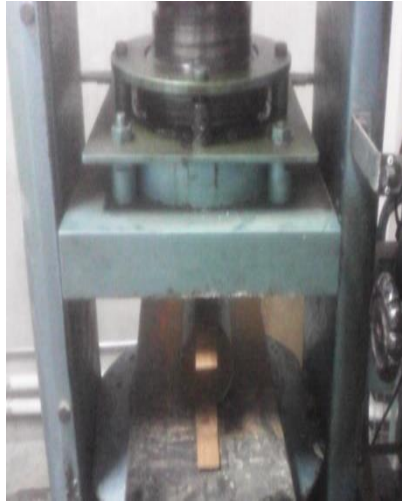
Figura 2. Montaje ensayo a tensión indirecta
