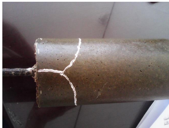
Figura 6. Falla ensayo pull-out
