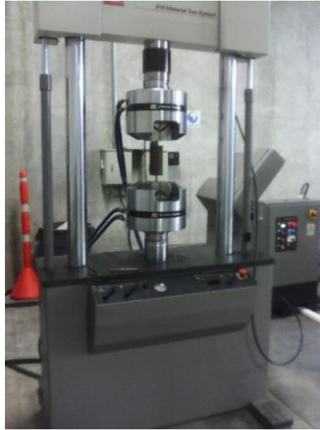
Figura 4. Montaje ensayo de adherencia
