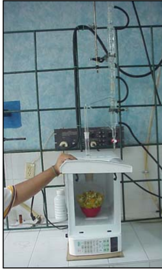
Figura 19. Montaje realizado para la extracción de los aceites esenciales de naranja y mandarina empleando hidrodestilación asistida por microondas.
