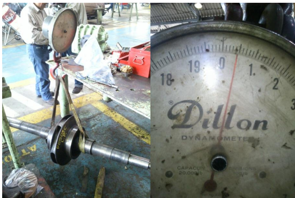
Figura 60. Medición del Peso del Eje e Impulsor de la P2503C en el Taller.
