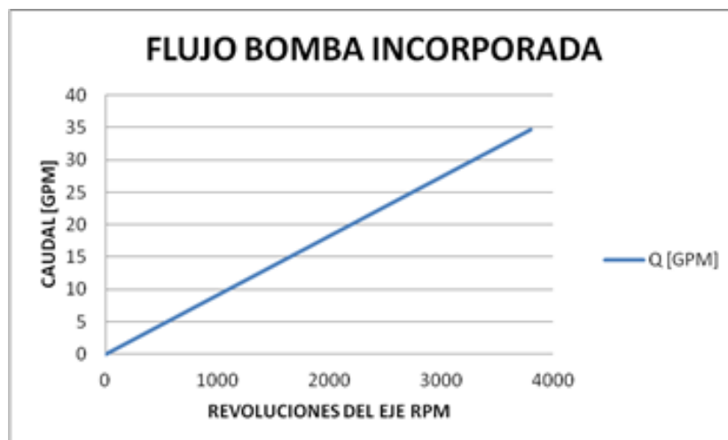
Figura 66. Flujo Bomba de Engranajes vs Revoluciones del eje principal.
