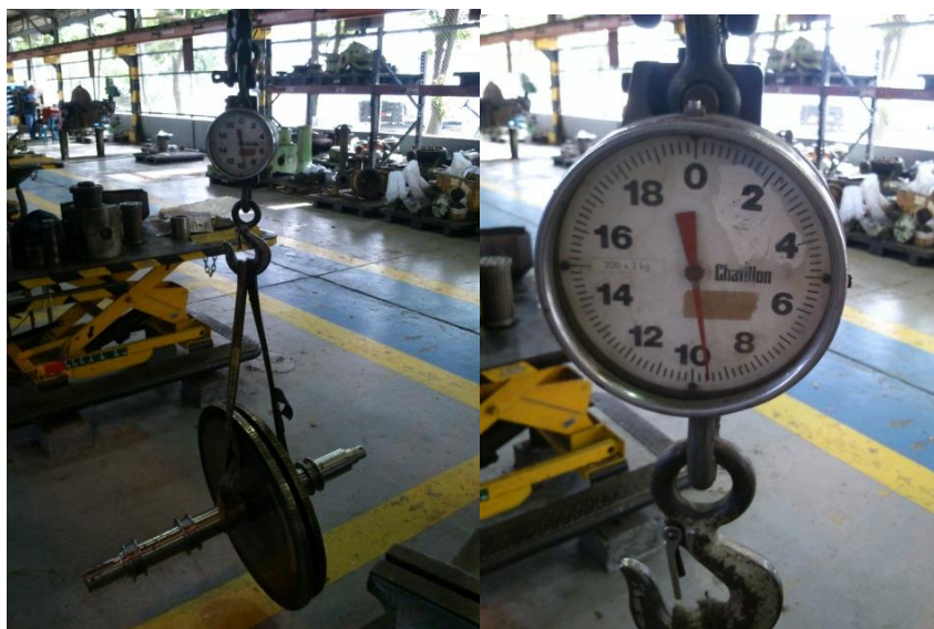
Figura 59. Medición del Peso del Eje y Alabes de la NP2503C en el Taller.
