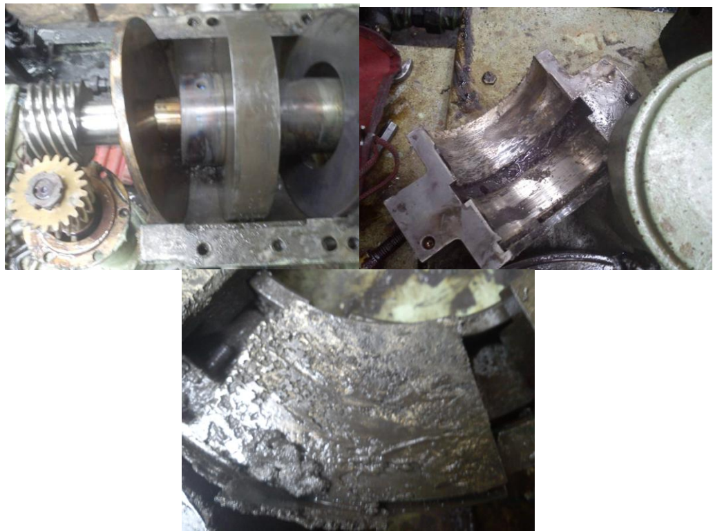
Figura 48. Daño en los Cojinetes Axiales y Radiales de la Bomba.
