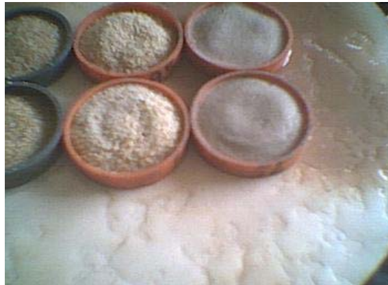
Figura 33 Muestras saturadas listas para ser colocadas en las ollas. Barrera y Muñoz (2003)
