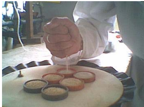
Figura 32 Preparación de las muestras sobre las piedras porosas. Barrera y Muñoz (2003)
