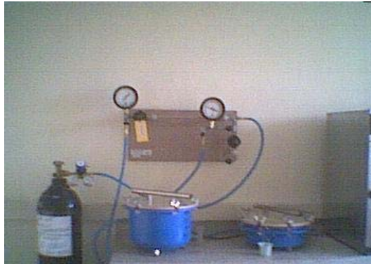
Figura 4.2. Ensayo de olla de presión, Barrera y Muñoz (2003)
