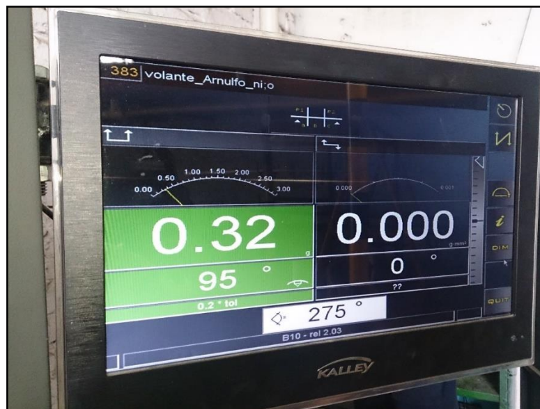
Figura 63. Medida final de desbalanceo en el conjunto Eje – Volante
