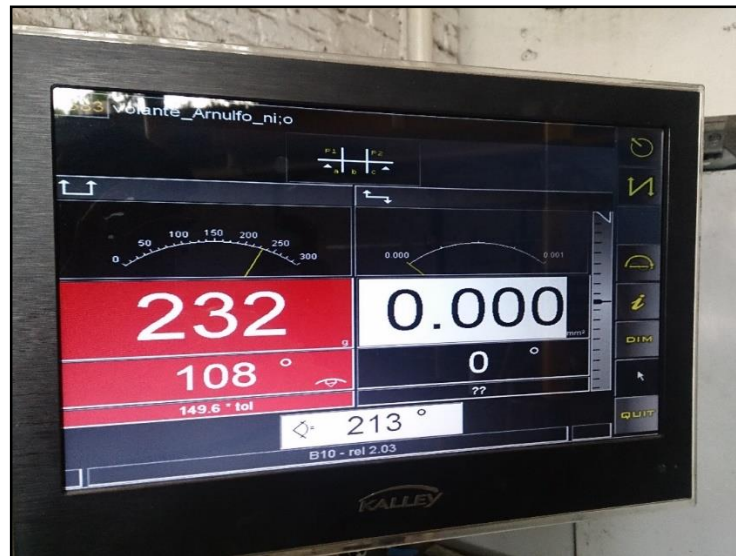
Figura 62. Medida inicial de desbalanceo en el conjunto Eje – Volante
