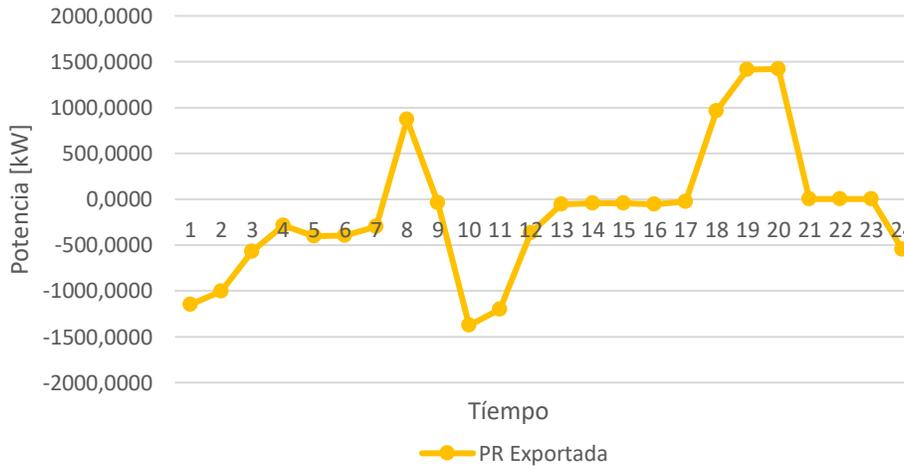
Nota: Gráfica detallada del comportamiento de la potencia inyectada por los VE por horas en un día para el segundo caso de estudio.
