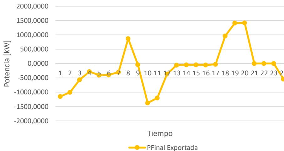
Nota: Gráfica detallada del comportamiento de la potencia inyectada por los VE por horas en un día para el primer caso de estudio.
