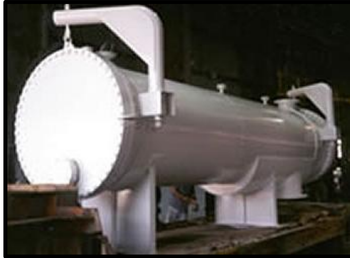
Figura 28. Intercambiador de calor
