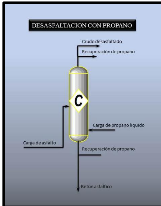
Figura 5. Desasfaltación con propano
