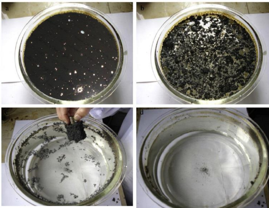
Figura 17. Proceso de eliminación de petróleo pesado en aguas superficiales con el MEG preparado. a) Aspecto del aceite flotando en la superficie del agua. b) se agregó MEG. c) MEG saturado con aceite separado por un pequeño imán. d) El agua limpia después de extraer el aceite del motor por MEG
