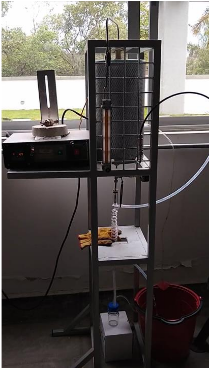
Figura 14. Banco de descomposicion y degradacion termica
