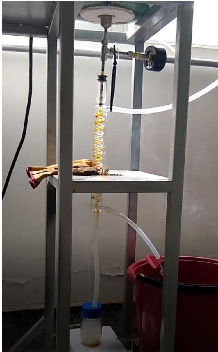
Figura 15. Inicio de formación de bioaceite
