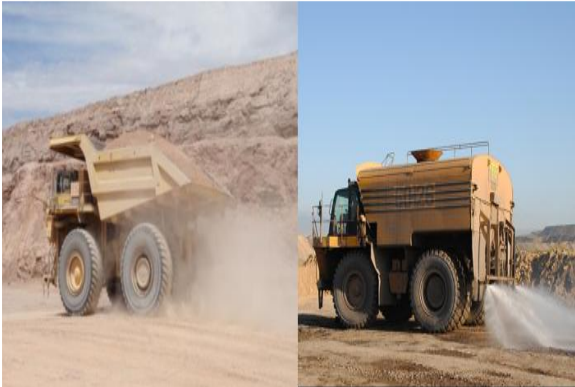
Figura 15. Levantamiento de polvo y riego de carreteras
