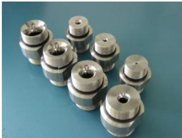
Figura 55. Foto de boquillas de 250, 150 y 100 m 3 /h y carcasas de boquillas de 50, 25, 12.5 y 3 m 3 /h construidas.
