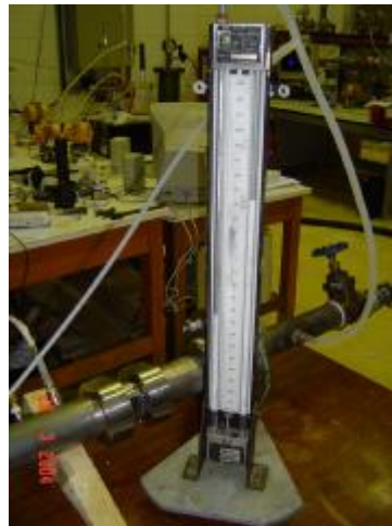
Figura 86. Manómetro de columna instalado durante el ensayo de estanqueidad.
