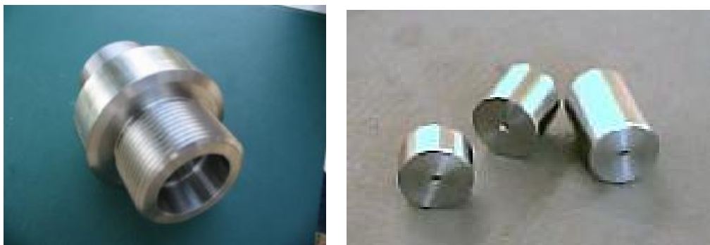
Figura 54.Foto de carcasa de la boquilla de 50 m 3 /h construida y los insertos de 3, 12.5 y 25 m 3 /h.
