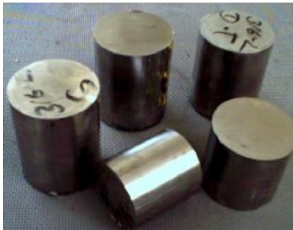
Figura 48. Redondos de acero inoxidable AISI 316L para la fabricación de las boquillas sónicas.
