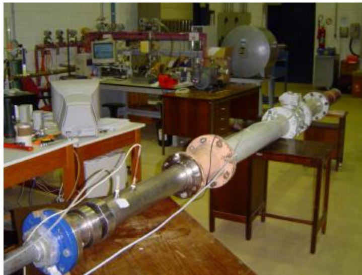
Figura 84.Instalación para calibración de boquillas con patrón tipo turbina.
