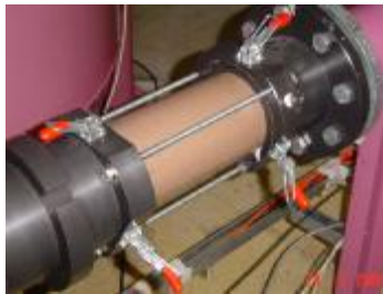
Figura 23.Montaje de la boquilla según alternativa con Clamps.
