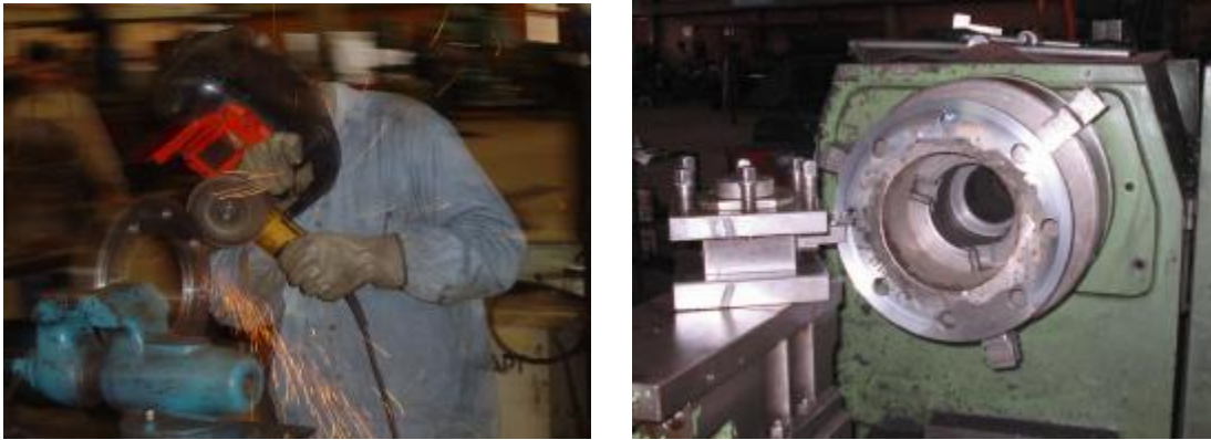
Figura 69. Imágenes de proceso de esmerilado (izquierda) y torneado (derecha) de las bridas.
