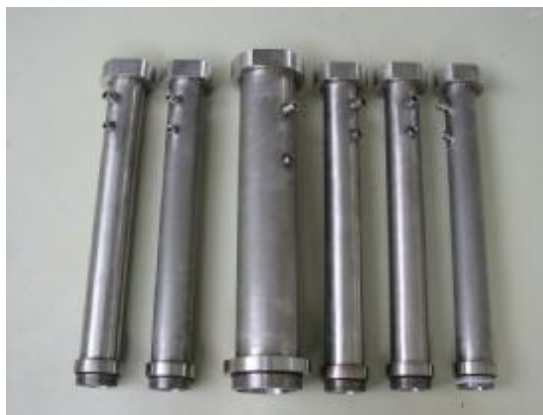
Figura 77. Tubos soldados y terminados
