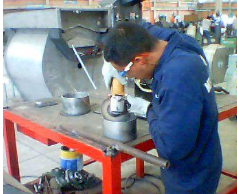
Figura 67. Proceso de esmerilado de las superficies soldadas y cortadas.
