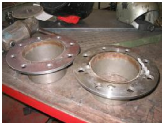
Figura 70. Imágenes de las bridas y los tubos para conexión de los plenums.
