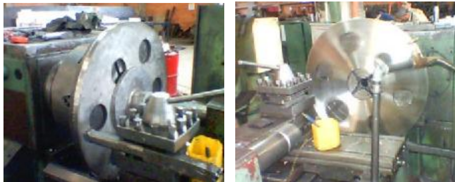
Figura 64. Imagen de montaje de placas frontales de los plenums en el torno.
