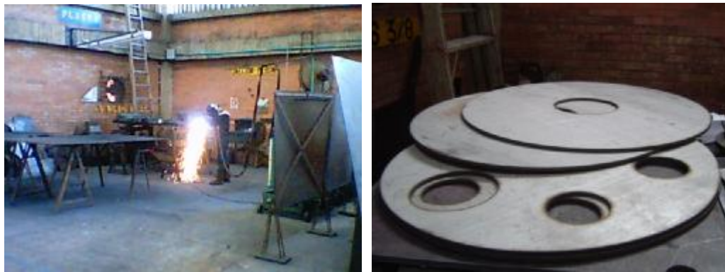
Figura 61. Imágenes de laminas cortadas para fabricación de plenums
