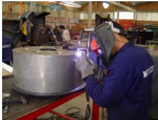
Figura 65. Proceso de soldadura de los plenums.
