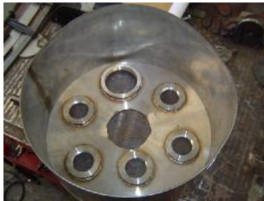
Figura 66. Acoples soldados en la cara interna de los plenums.
