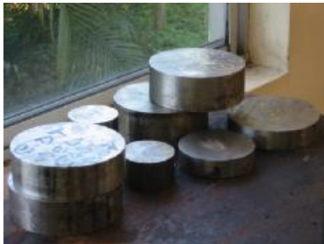
Figura 56.Foto material acero inoxidable AISI 304, para fabricación de acoples
