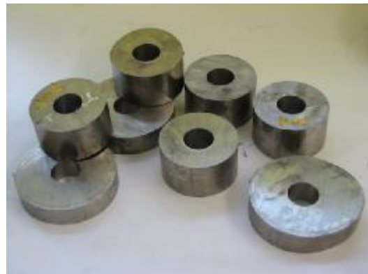
Figura 57. Material perforado para la fabricación de acoples
