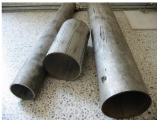
Figura 59. Tubería adquirida para la construcción de las líneas de flujo.
