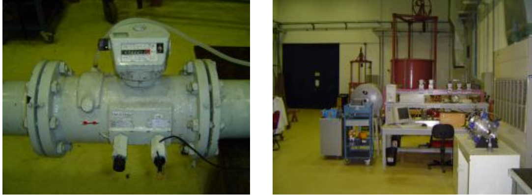
Figura 82. Patrones de calibración de las boquillas sónicas, turbina (izquierda) y campana gasométrica (derecha)
