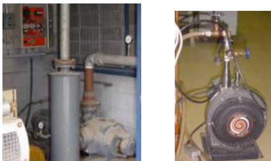
Figura 83. Imágenes de bombas de vacío empleadas en la calibración, bomba para boquillas grandes (izquierda) bomba para boquilla de 3 \text{ m}^3/\text{h} .
