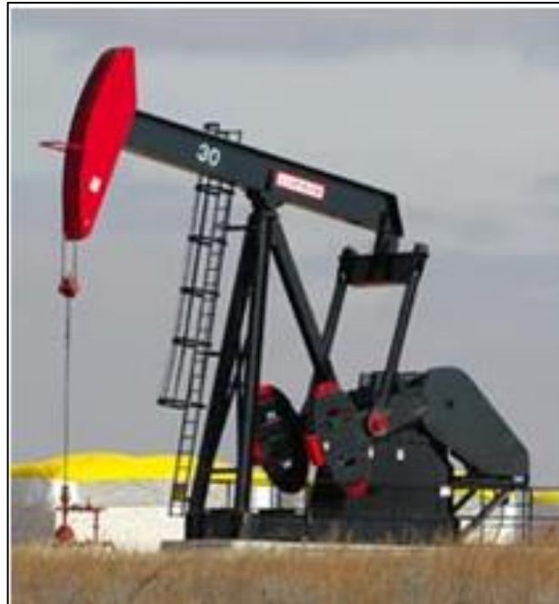
Figura 10. Unidad de bombeo convencional
