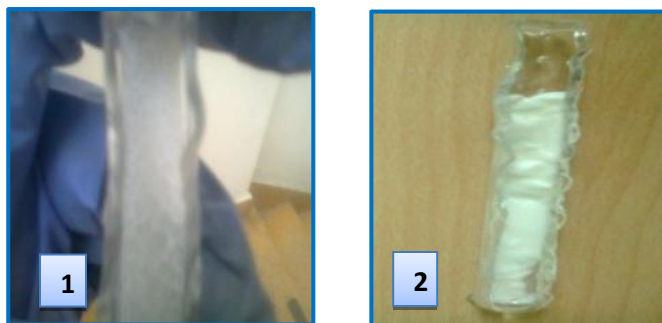
Figura 10. PNIPAM sintetizado mediante método combinado. 1. PNIPAM sin entrecruzante. 2. PNIPAM con entrecruzante
