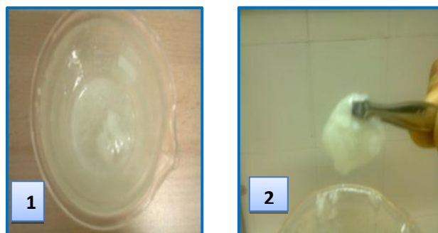
Figura 11. PNIPAM sintetizado mediante microemulsión inversa. 1. PNIPAM sin entrecruzante. 2. PNIPAM con entrecruzante
