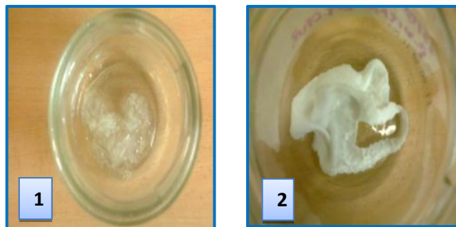
Figura 9. PNIPAM sintetizado mediante fotopolimerización. 1. PNIPAM sin entrecruzante. 2. PNIPAM con entrecruzante
