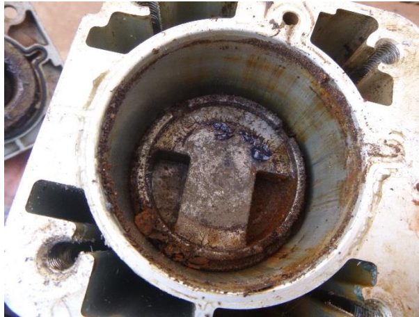
Ilustración 18. Suciedad en el pistón del actuador neumático.
