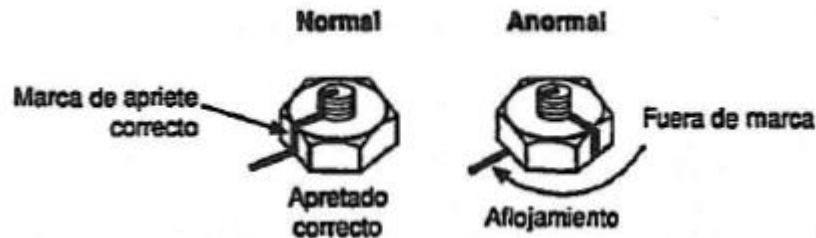
Ilustración 7. Ejemplo de ajuste correcto de tuercas
