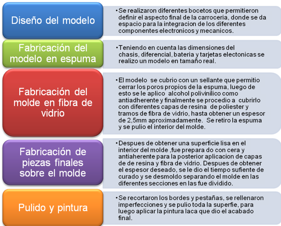
Figura 97. Proceso de fabricación de la carcasa en fibra de vidrio.
