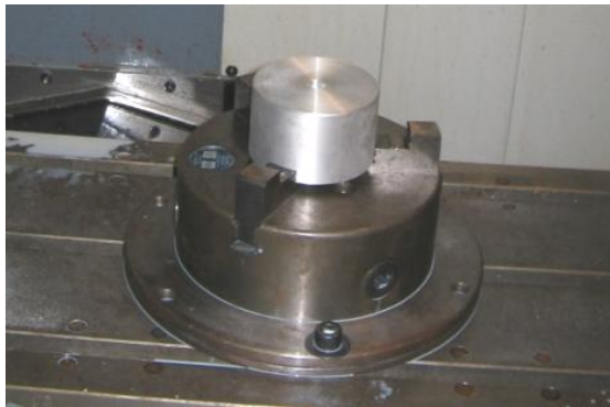
Figura 87. Sujeción de las masas pre-mecanizadas de los rines por medio de una prensa de mordazas radiales
