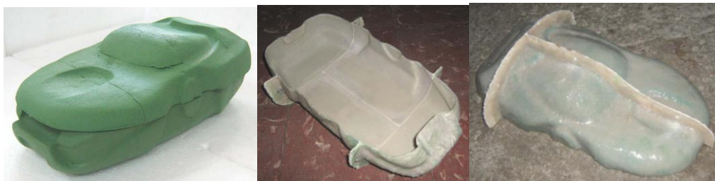
Figura 98. Etapas dos y tres del proceso de fabricación de la carcasa.
