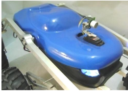
Figura 99. Aspecto final de la carcasa sobre la estructura del chasis.
