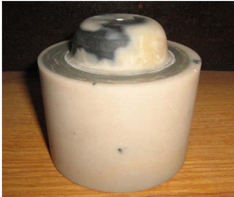
Figura 85. Modelo para la fundición de las masas base construido en resina.
