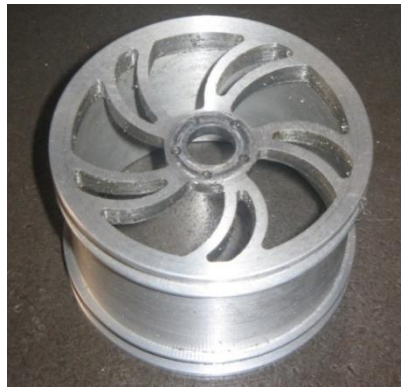
Figura 93. Aspecto final del rin después de todas las operaciones de mecanizado.
