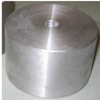
Figura 86. Resultado del proceso de pre mecanizado de las piezas en torno convencional
