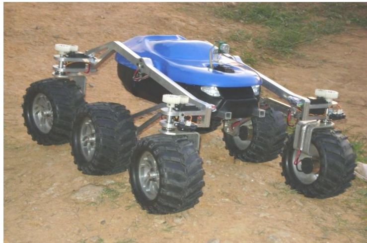
Figura 107. Ensamble final del sistema de locomoción y la carcasa.
