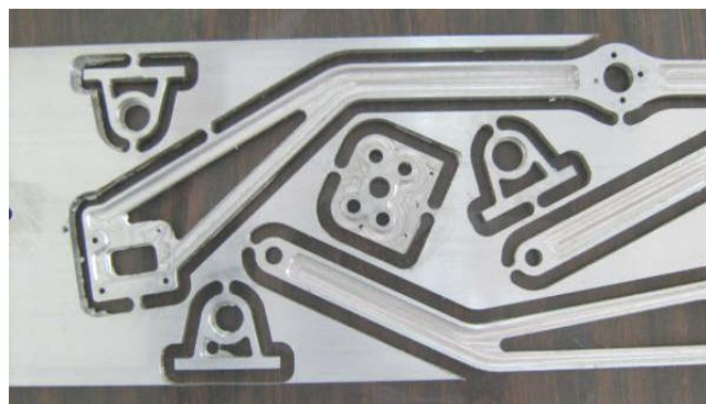
Figura 75. Resultado del mecanizado aplicando la estrategia propuesta.
