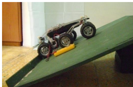
Figura 162. Prueba de capacidad de desplazamiento por terrenos inclinados.
