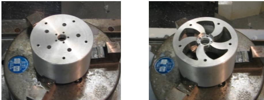
Figura 89. Aspecto de la pieza después de los taladrados (izquierda) y después de abrir las ventanas grandes y hacer el vaciado en la parte central (derecha).
