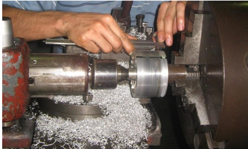
Figura 92. Montaje de los rines en torno para su mecanizado final.
