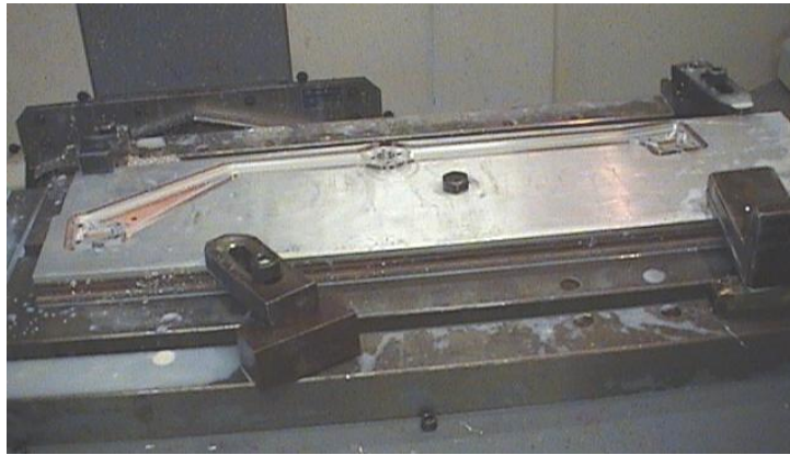
Figura 79. Sujeción de la platina por medio de uñas y tornillo.
