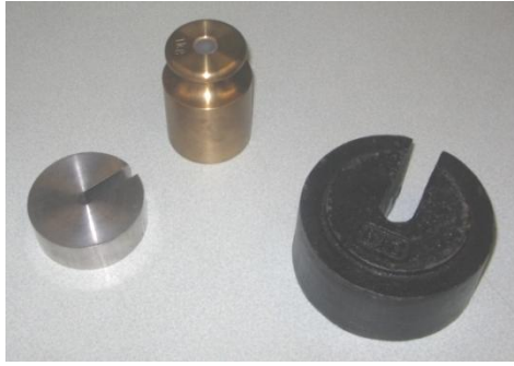
Figura 179. Masas utilizadas para simular la carga sobre las ruedas.
