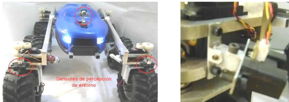
Figura 158. (Izquierda) Integración de los sensores de percepción de entorno. (Derecha) Junta universal utilizada como soporte de los sensores.
